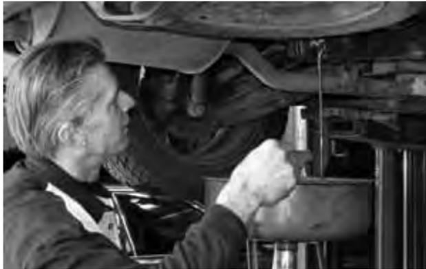
Su auto requiere atención especial antes de emprender un viaje: **\* El sistema de refrigeración:** Es necesario vaciar y volver a llenar el sistema de refrigeración al menos una vez al año para mantener el sistema en condiciones óptimas de funcionamiento. Si no ha cambiado el refrigerante durante el último año, haga vaciar el radiador y vuélvalo a llenar antes de comenzar el viaje.
