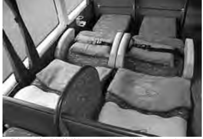
El Servicio "Suite" de 22:40 hs, es un coche cama doble piso, con inclinación regulable de hasta 180° y una superficie por pasajero de 0,90 x 1,80 metros.
