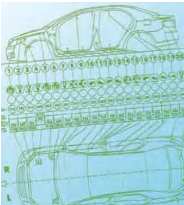
El monitoreo computarizado 3D, permite un ajuste exacto de la recomposición del vehículo, llevándolo a sus medidas originales de fábrica con precisión.
